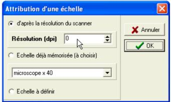
Lorsque le pilote de scanner n'est pas lancé depuis Mesurim, mais à partir d'un autre logiciel, enregistrer l'image puis se reporter à l'utilisation de l'outil Image/ Créer, modifier une échelle décrite dans le paragraphe A (Appareil photo numérique).
