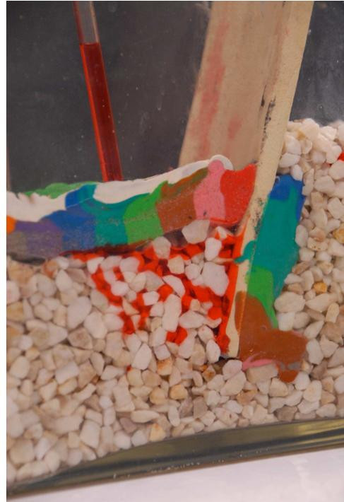
**« Pétrole » injecté sous la couche imperméable**
