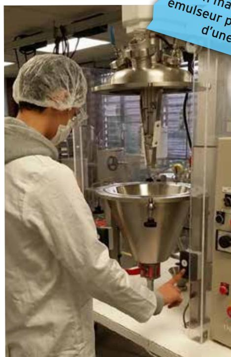
Mise en marche du mélangeur émulseur pour la fabrication d'une émulsion
